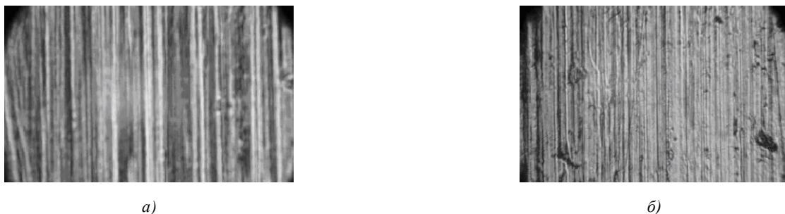
Рис. 4. Поверхность стали 12X18H10T (вид сверху а) – после точения; б) – после точения и алмазного выглаживания (ув. × 2500)
