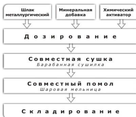
Рисунок 2. Принципиальная технологическая схема производства шлаковых цементов бесклинкерным способом
