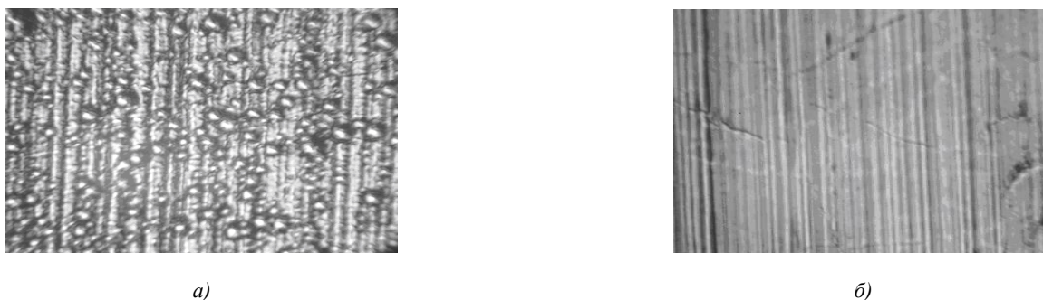
Рис. 5. Поверхность стали 45: а) – с нанесённым слоем хрома и ультра алмазами после точения; б) – после точения и алмазного выглаживания слоя хрома и ультра алмазами (ув. × 2500)
